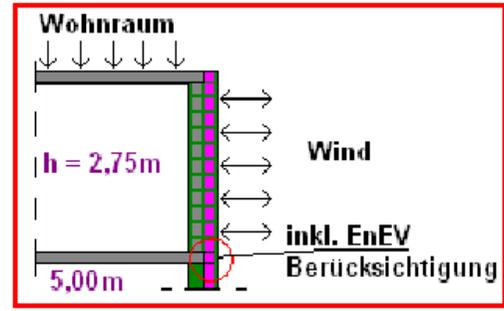
Vorteilhafte Lastabtragung durch vollflächige Aufstandsfläche statt Mauerwerksüberstand bei monolithischen Wandaufbauten!
